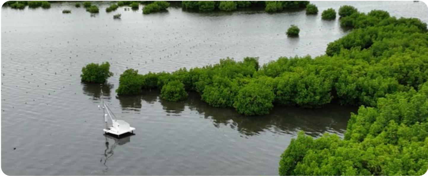
No projeto de recuperação da WeForest e da Oceanium em Sine-Saloum, Senegal, duas torres de fluxo estão medindo a troca de carbono entre as plântulas em crescimento e a atmosfera, ajudando a compreender melhor os benefícios ecológicos da recuperação manguezais. © N. Van Ingen.
